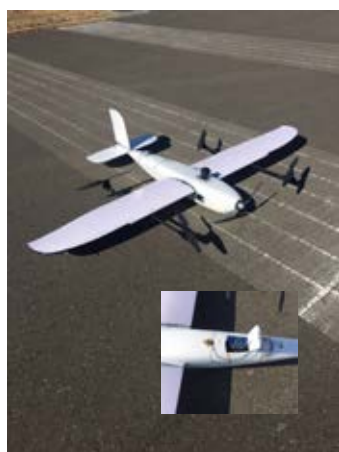
垂直離着陸型ドローンに取り付けた日射計と 飛行試験の様子
