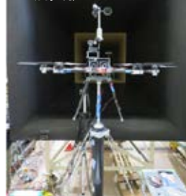
風況計測ドローンの風洞実験
