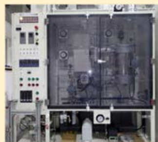
アンモニア合成触媒活性評価 (高圧)
