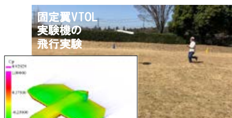
VTOL周りの流れの CFDシミュレーション
