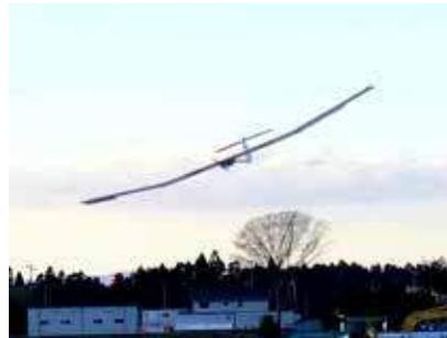
固定翼に搭載した太陽電池モジュールと飛行試験の様子
