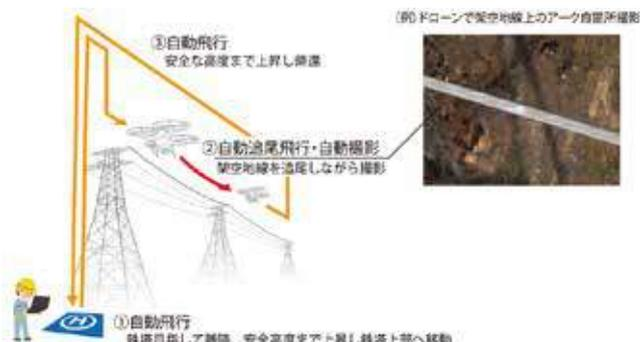
アルプスアルパインが開発した送電設備用自動点検システム
