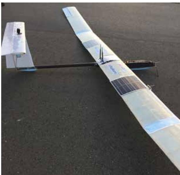
本事業で作製した太陽電池搭載型固定翼ドローン
