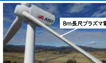
FREA300kW風車（ブレード長16.5m） での実環境耐久試験
