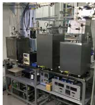
水電解の除湿実証試験機
