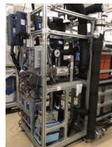
ヒートポンプ用スクロール圧縮機試験装置
