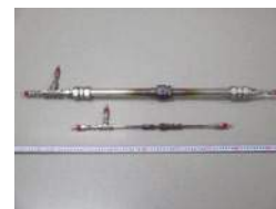
ラボスケールと実証スケール 水素透過試験ホルダーの一例
