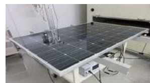
単結晶型モジュール 融雪温度上昇試験
