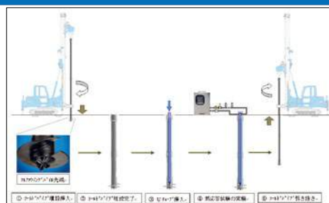
低コスト熱応答試験 施工概略図
