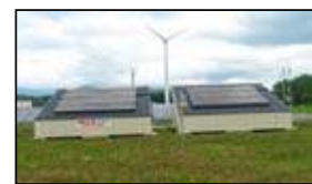
模擬屋根による試験環境設備
