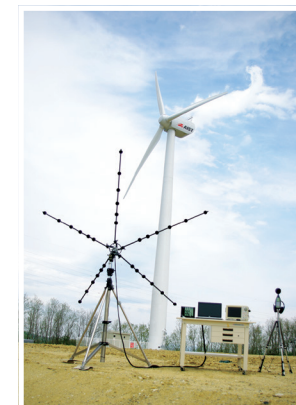
音響センサーによる騒音測定
