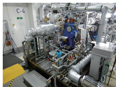
1メガワット級コジェネシステム用水素専焼エンジンの開発
