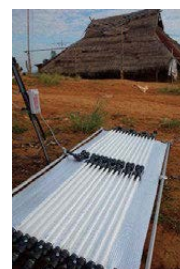
光触媒による飲料水浄化試験（タイ・チェンライ県アカ族集落）、大腸菌群数と紫外光強度に良い逆相関が見られる
