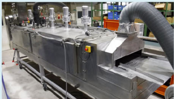
急速冷却基本システム
