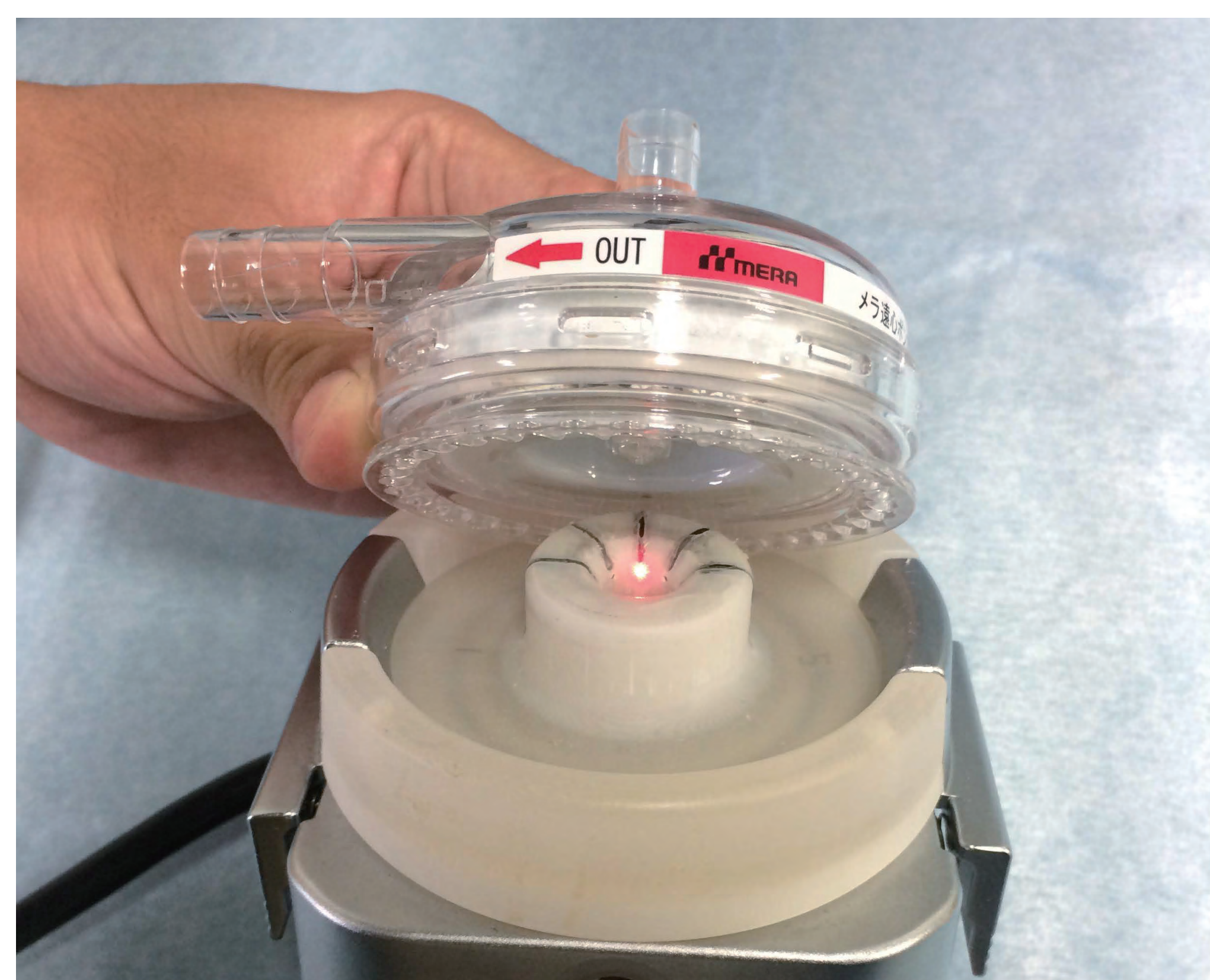
血液ポンプ内の血栓のモニタリングシステム Thrombus monitoring system in blood pump
