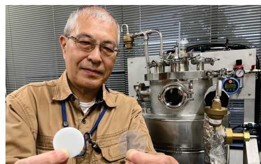
焼結石英を持つ近藤。 右手がSD造粒体、左手がSFGD造粒体から作製したもの。 SFGD造粒体から作製すると透光性の高い焼結石英が得られる。
