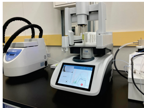
MPIプラットフォームに整備したマイクロ波ナノ粒子合成装置（CEM社製 Discover 2.0）の外観
