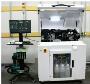
写真2 部品試作用三次元粉末積層造形装置
