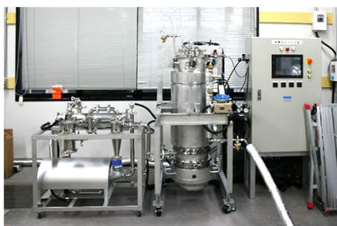
写真1 噴霧凍結造粒装置
