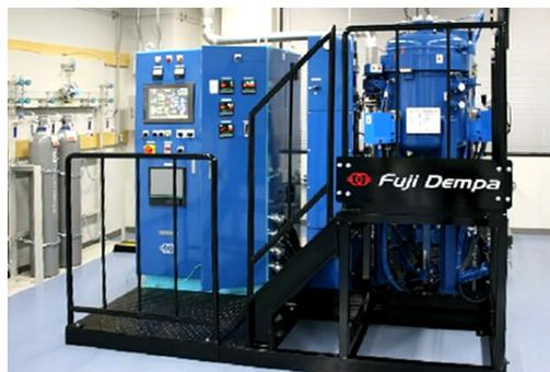
写真6 次世代電子材料向け絶縁高伝熱セラミックス基板製造等の特殊焼結炉
