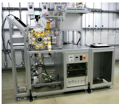
写真4 マルチスケール気相成長装置
