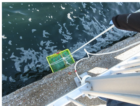
写真 海洋生分解性プラスチック試料を入れたカゴを海中へ浸漬する様子（東京湾）
