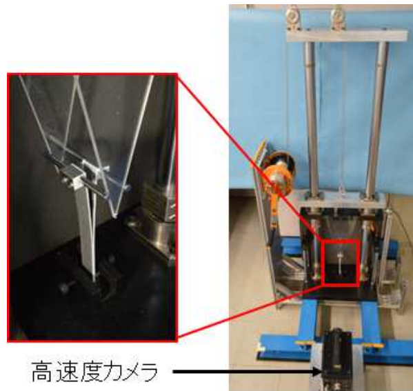
図2 衝撃 DCB 試験装置と試験の様子
