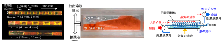
開発した各種要素技術の概略図 (左からスラグ長さを変化させたスラグ流発生の様子、連続液液分離の様子、連続蒸留分離装置の概略図)
