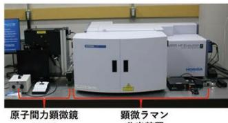
専用の金属コートAFM探針先端に発生する近接場光を利用することでナノスケールの空間分解能と高い測定感度を実現
