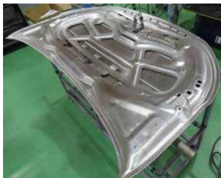
150℃以下のプレス成形により試作した開発合金製自動車フロントフード（千野ら：軽金属 73 (2023) 168-174.）
