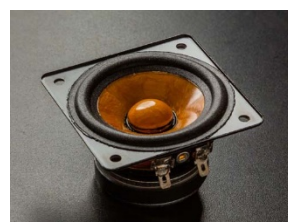
作製したスピーカー振動板をユニットにアセンブリ
