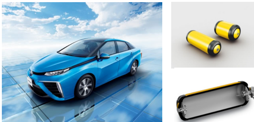
トヨタFCV「MIRAI」と高圧水素タンク
