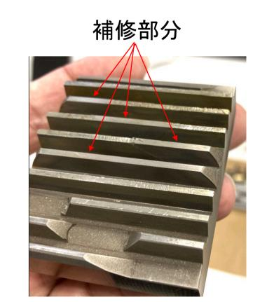
SPCCテスト材へのインコネルによる補修に成功
