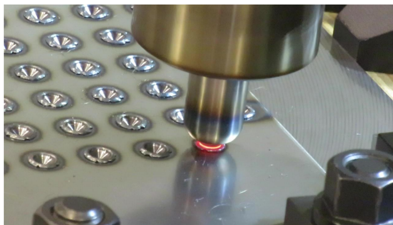
開発材料ツールを用いたSPCC鋼板の摩擦攪拌点接合の外観(2000打点付近)とツール先端の形状変化
