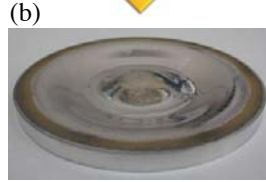
図2(a) 従来のマグネトロンカソードの概略、(b)マグネトロンカソードの使用により、ドーナツ状に侵食されたターゲット表面の例。
