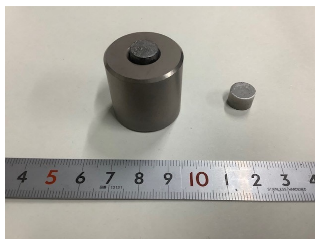
図5 開発材製焼結型、及びこの型を用いて1300℃で焼結したアルミナ焼結体(相対密度ほぼ100%)の外観
