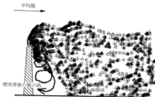
図4-2 煙突によるダウンウォッシュ
