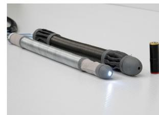
細径配管内点検ロボット
