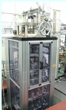
高圧標準を実現するための大型の重錘形圧力天びん
