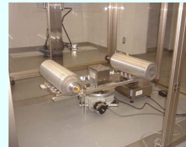
環境分析装置のための標準ガスの調製 (写真: 産総研NMIJ 有機分析科 ガス標準研究室)
