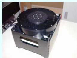
汎用型角度標準器 自己校正機能付 角度検出器(SelfA) 日本・タイ・インドネシア 韓国・中国が導入
