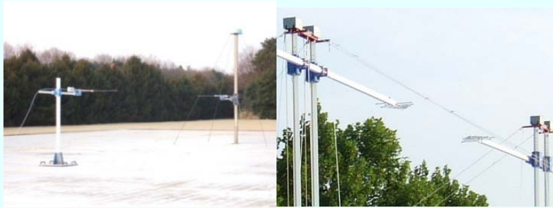
ダイポールアンテナ標準測定の様子
