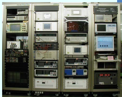
電力・電力量校正装置
