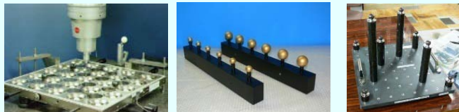
ボールプレート ボールステップゲージ 簡易検査ゲージ
