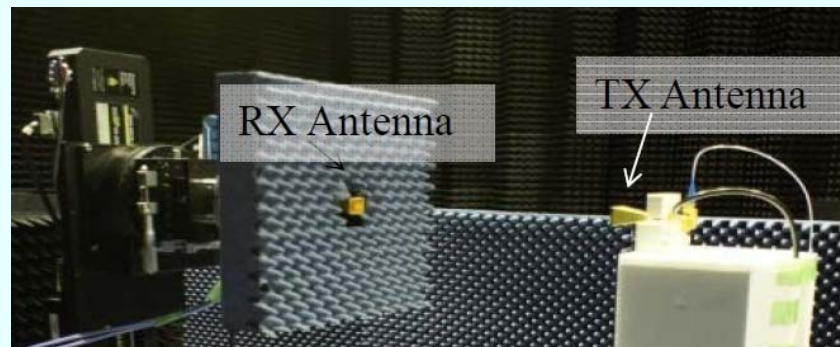
光デバイスを用いたミリ波アンテナ特性測定の様子
