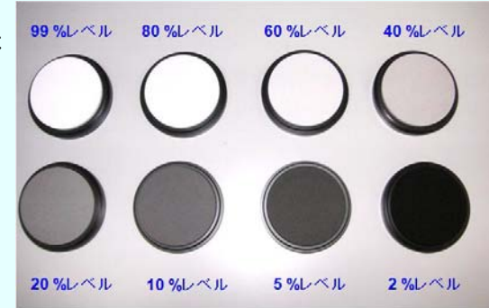
国家標準トレーサブルな標準拡散板の例
