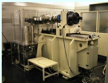
開発した1 kN・mトルク標準機
