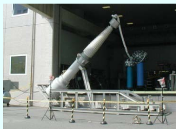
標準計器用変圧器( 550/\sqrt{3}kV )
