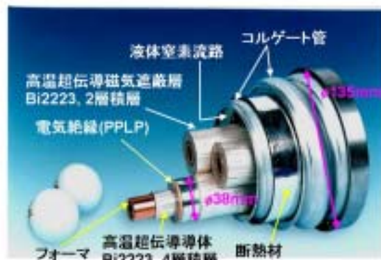
高温超伝導ケーブルの構造(住友電工)
