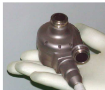
メカニカルシール遠心型 サンメディカル技術研究所 EVAHEART
