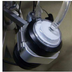
部分循環補助用 磁気動圧軸受斜流ポンプ HeartWare社Synergy 臨床16例以上、最長213日
