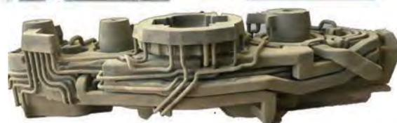
積層造形した鋳型を用いて開発した航空機ギヤボックス
