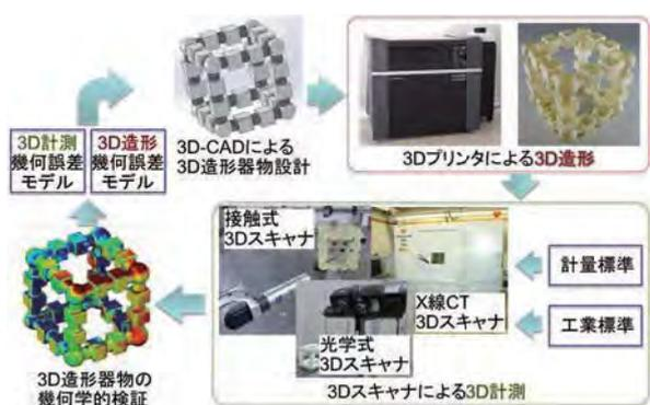
3D計測誤差・3D造形誤差の評価技術・補正技術への取り組み
