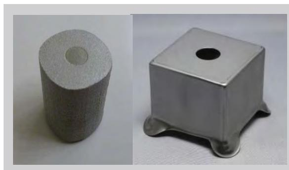
金属積層造形によるポーラス構造と箱形状の逐次成型
