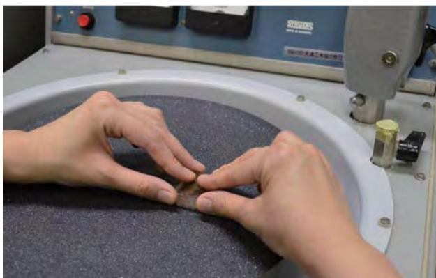
樹脂包埋したイモゴライトを乾式研磨法で研磨している様子
