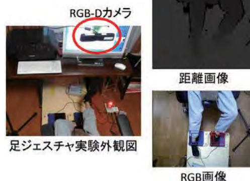
足認識モジュール：フットペダルを踏むのと同じ動作を認識
