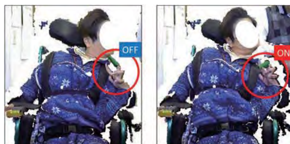
指認識モジュール：指の折曲げをスイッチに（大きな不随意運動を含む）
