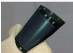
消費電力量の見える化を実現する フィルム型電流センサ：72
