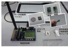
超小型完全固体型 pH センサ・無線機能：63
