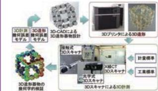
3D スキャナで評価する3D プリンタの精度：102
