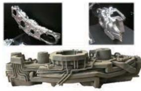
3D プリント技術：鋳造用砂型積層および金属積層造形：100
