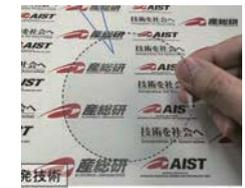
微細構造の毛細管力を利用した超高精細・厚膜印刷 : 98
