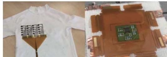
極薄シリコン搭載ストレッチャブル無線センサデバイス：71
