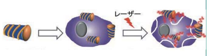
光照射で効率的に発熱するナノコイル状の新素材：79
