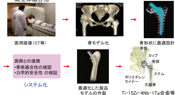
整形インプラントの設計製造プロセス
