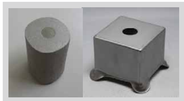
ポーラス構造（積層造形）と箱形状（逐次成形）
