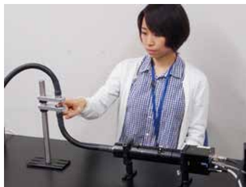
試作した高感度分光分析装置
