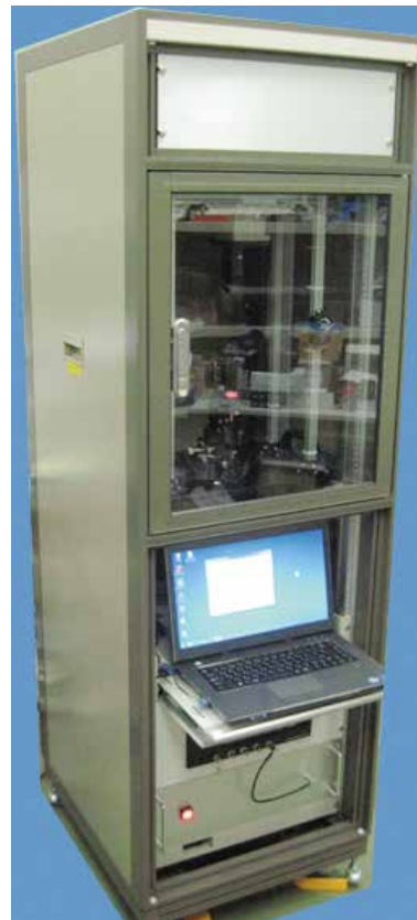
非接触・実時間弾性率測定装置(試作)
