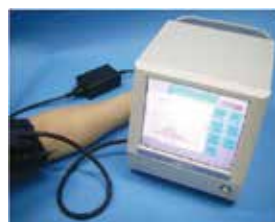
各種生理・生体計測技術 ・血圧計を利用した動脈硬化度評価装置（左） ・超音波画像診断装置による血管、血流評価（右）
