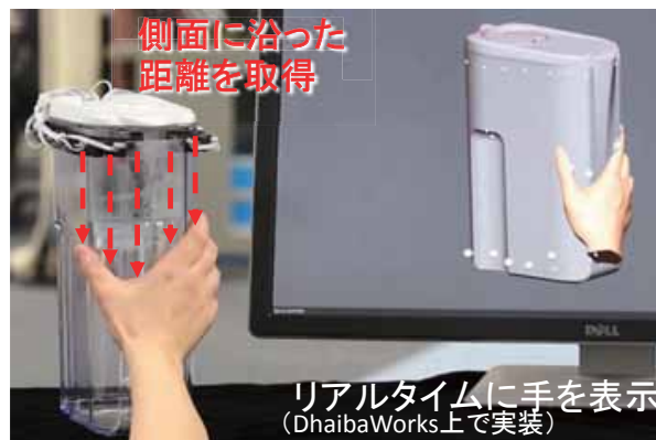
製品にバンド型センサを巻きつけて把持姿勢を推定
