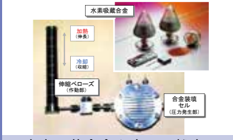
水素吸蔵合金を応用～静音で 柔軟なアクチュエータ : 19
