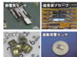
超低電力無線センサを実現～圧電 MEMS デバイス : 76
