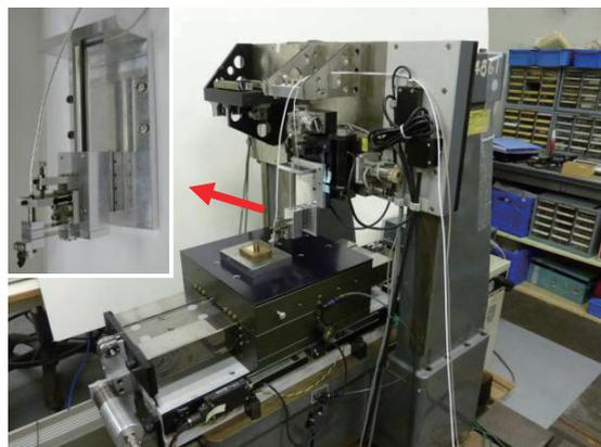
工具ホルダを搭載した門型3軸ステージ
