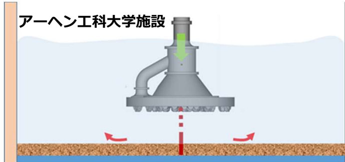
TEST A) 掘削時の土粒子拡散試験
