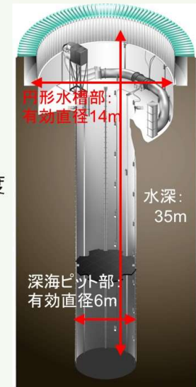
試験施設(深海水槽)
