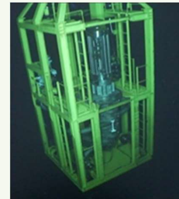
海底熱水鉱床パイロット試験の水中ポンプ (JOGMEC提供)
