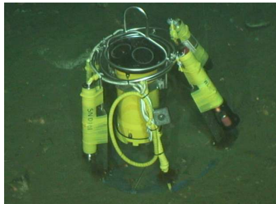
CTD/流向流速計/溶存酸素計/濁度計
